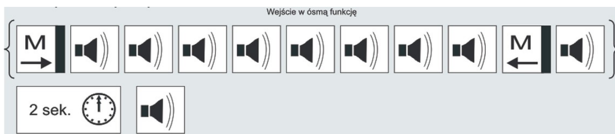
Rys.8 Usuwanie identyfikatorów użytkowych
